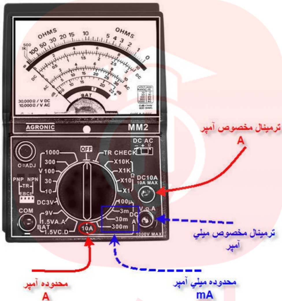
شکل b ۱۵ - محل قرار دادن پراب ها و محدوده آمپراژ در مولتی متر های آنالوگ
