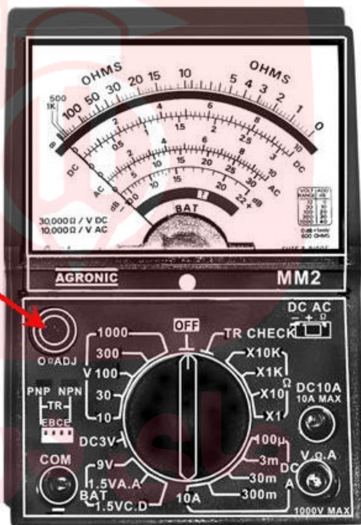
شکل ۵- پیچ کالیبره کردن مولتی متر آنالوگ
