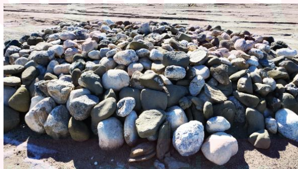
شکل ۱۳: سنگ‌های جمع‌آوری شده از بستر رودخانه جهت استفاده در ساختمان‌سازی توسط بومیان محلی
