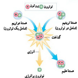
شکل ۱۴-۶ دوتریم و تریتم در هم گداخته می‌شوند تا هسته هلیوم تشکیل شود. در این واکنش، مقدار زیادی انرژی (حدود 17.6 \text{ MeV} ) آزاد می‌شود که بخش عمده‌ای از آن به صورت انرژی جنبشی نوترون است.
