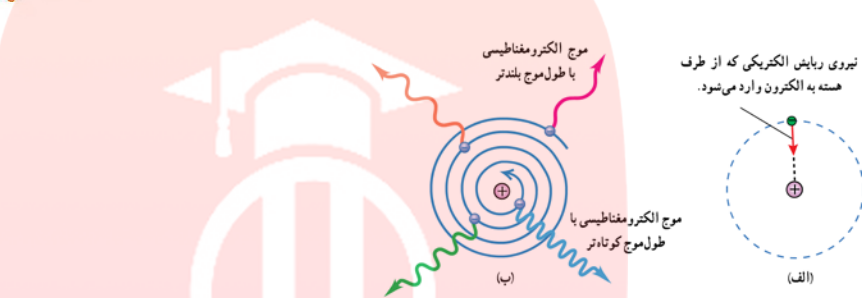
شکل ۱۳-۵ ناتوانی مدل اتم هسته‌ای رادرفورد در تعیین پایداری اتم. الف) اگر الکترون نسبت به هسته ساکن فرض شود بر اثر نیروی ریبایش الکتریکی، روی هسته سقوط می‌کند. ب) اگر الکترون دور هسته بچرخد، طیفی پیوسته گسیل می‌کند و سرانجام روی هسته فرو می‌افتد.
