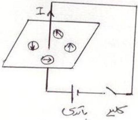
اوستد مدار ساده ای مطابق شکل ایجاد کرد، با بستن کلید و ایجاد جریان در سیم متوجه شد که عقربه های مغناطیسی از موقعیت قبلی خود چرخیده و به صورت شکل قرار گرفتند. از این آزمایش نتیجه گرفت که ایجاد جریان در سیم باعث ایجاد میدان مغناطیسی در اطراف آن شده و به عقربه های مغناطیسی نیرو وارد کرده است.
