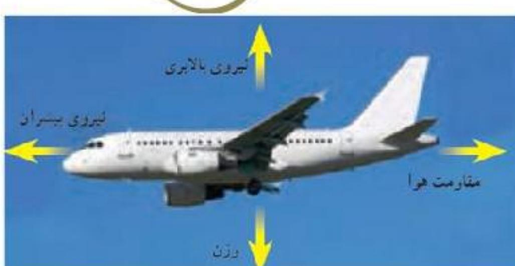
**نکته:** اگر در پرواز هواپیما، نیروی بالابری بیشتر از وزن هواپیما شود، هواپیما اوچ می گیرد و اگر نیروی بالابری کمتر از وزن شود، ارتفاع هواپیما کاهش پیدا می کند.
