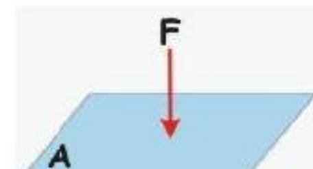
$$\text{فشار} = \frac{\text{نیرو}}{\text{سطح}} \quad \text{یا} \quad p = \frac{F}{A}$$
