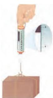
۱۵. نیروسنجه چگونه وزن اجسام را اندازه می گیرد؟ در داخل نیروسنجه یک فنر قرار دارد که می تواند کشیده شود
