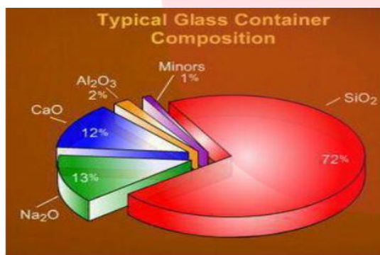
اجزای تشکیل دهنده شیشه معمولی
