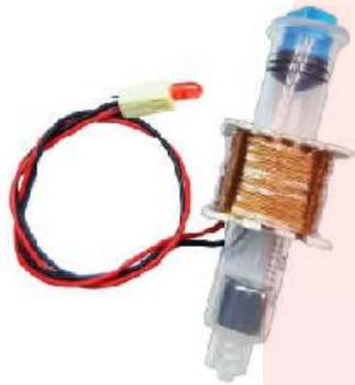
**نکته :** با استفاده از سیم پیچ تعداد دور سیم بیشتر و حرکت سریع‌تر آهن‌با و سیم پیچ می‌توان نور لامپ را بیشتر کرد.
