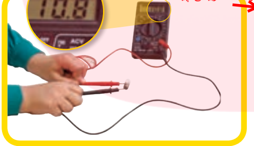
شکل ۸- اندازه‌گیری مقاومت لامپ خاموش با اهم سنج دو سر سیم را به دو طرف لامپ متصل می‌کنیم
