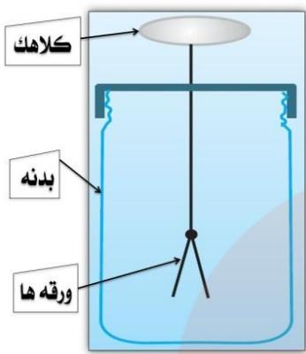
**الکتروسکوپ** وسیله‌ای است دارای یک ورقه‌ی طلا یا آلومینیوم که روی یک تیغه فلزی قرار دارد.
