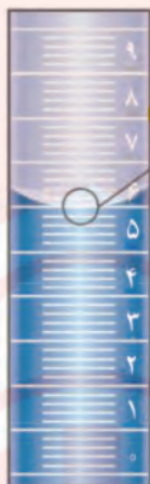
شکل ۵- از استوانه مدرج برای اندازه‌گیری حجم مایع استفاده می‌شود. این ظرف بر حسب سانتی‌متر مکعب مدرج شده است.
