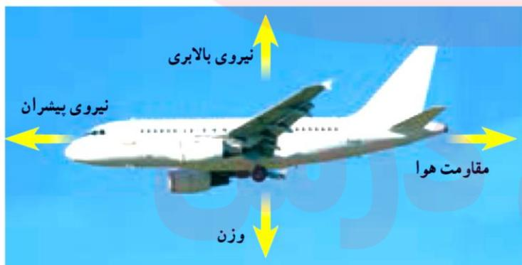
**نکته ۲ :** اگر در پرواز هواپیما، نیروی بالابری بیشتر از وزن هواپیما شود، هواپیما اوج می‌گیرد و اگر نیروی بالابری کمتر از وزن شود، ارتفاع هواپیما کاهش پیدا می‌کند.
