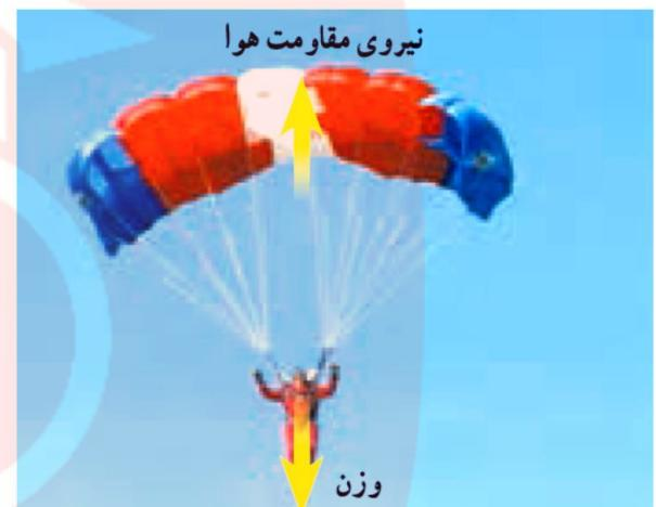
وقتی نیروی وزن وارد بر چتر باز و نیروی مقاومت هوایی هم اندازه باشند، چتر باز با سرعت ثابت به طرف زمین حرکت می‌کند.
