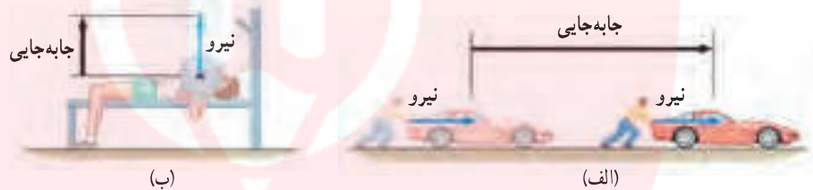
شکل ۲- انجام دادن کار در دو حالت مختلف؛ توجه کنید که نیرو و جاب‌جایی در یک جهت‌اند.
