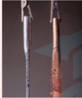
تغییر شکل تیغه ها پس از کار کردن در سلول گالوانی روی-مس
