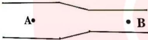
در شکل روپرتو آب با تندی  $12 \frac{\text{m}}{\text{s}}$  از مقطع  $A_1$  عبور کرده و به مقطع  $A_2 = 25 \text{ cm}^2$  می رسد.
