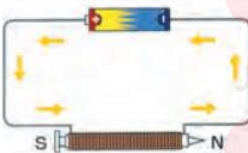
**نکته:** اگر چهار انگشت دست راست خود را در جهت جریان الکتریکی به دور سیم پیچ بچرخانیم، انگشت شست، قطب شمال (N) آهن ربای الکتریکی را نشان می دهد.
